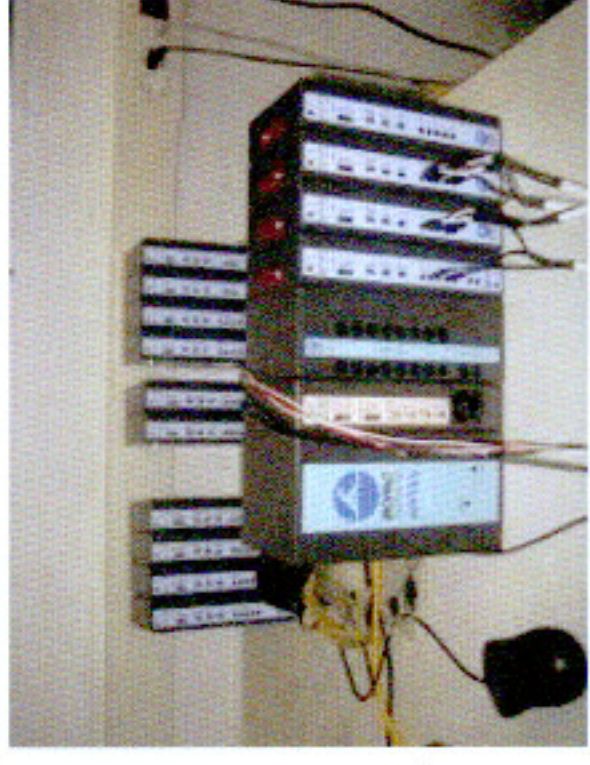
Descripción: Equipo de adquisición de datos fisiológicos. BIOPAC MP150
