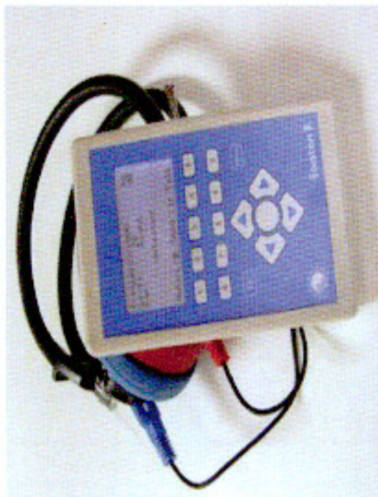
Descripción: Portable Audiometer. Lafayette Instrument 15015
