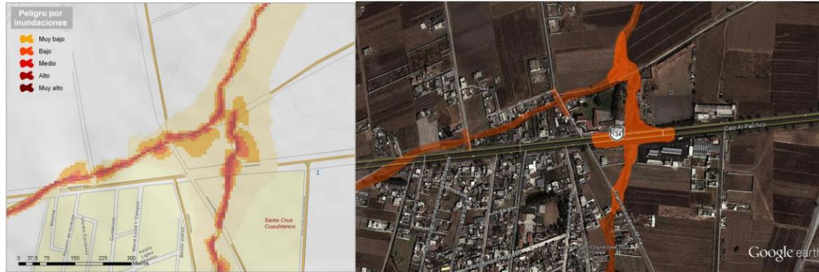
Escurrimiento (río Chiquito) canalizado en la colonia Bosques ICA residencial / Serratón. Como se observa el río está contenido por fuertes muros de concreto que evitan que el río desborde y genere problemas de inundación. Sin embargo al sur de S Lerdo de Tejada las viviendas en los cauces tienen problemas de inundación (arriba modelo de inundación, imagen satelital abajo).
