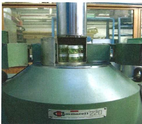
Irradiación en el Gammacell 220 del ININ
