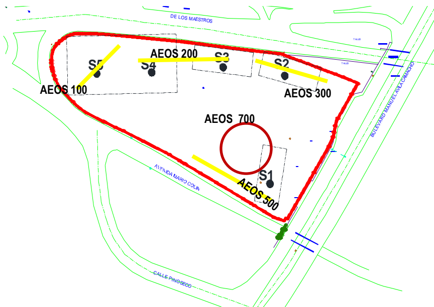
Figura 2.1. Ubicación de las mediciones de ondas superficiales, Fuentes: Activa (líneas amarillas) y Pasiva (círculo café).
