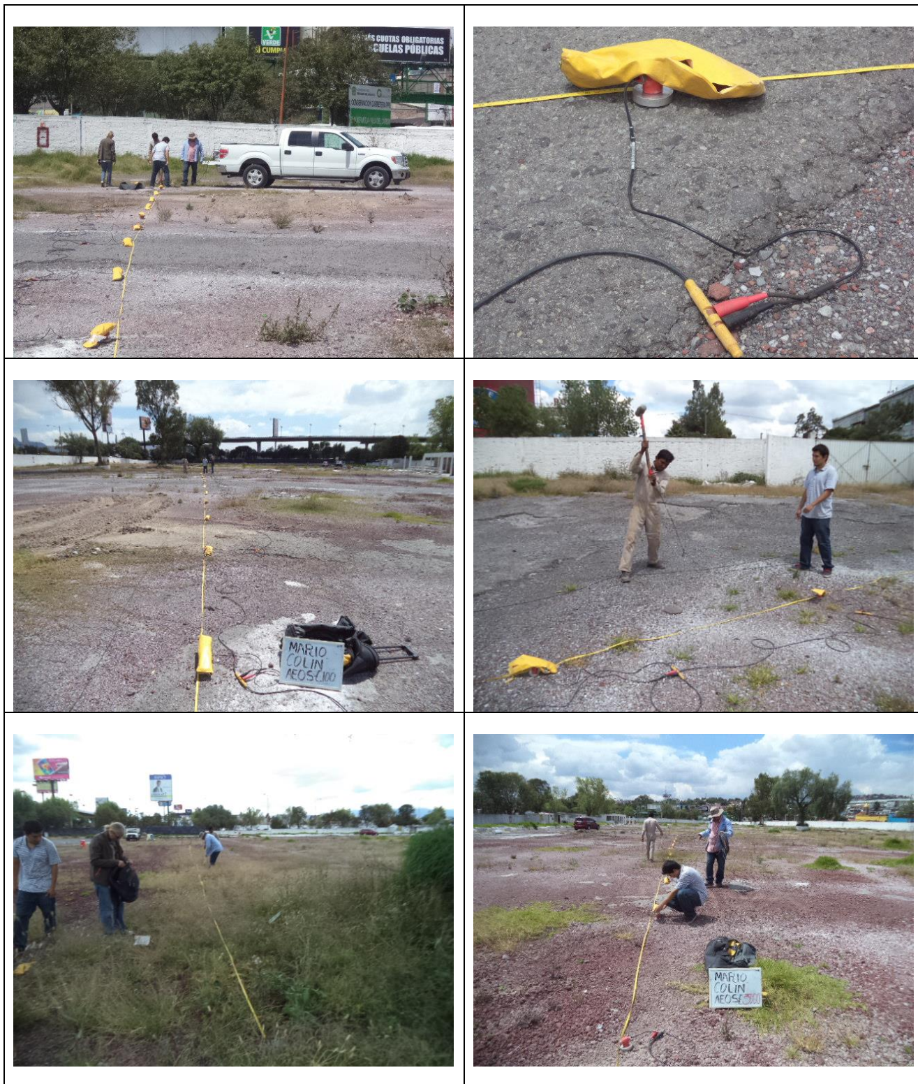
Figura A.14.- Tendidos del Análisis Espectral de Ondas Superficiales (AEOS).
