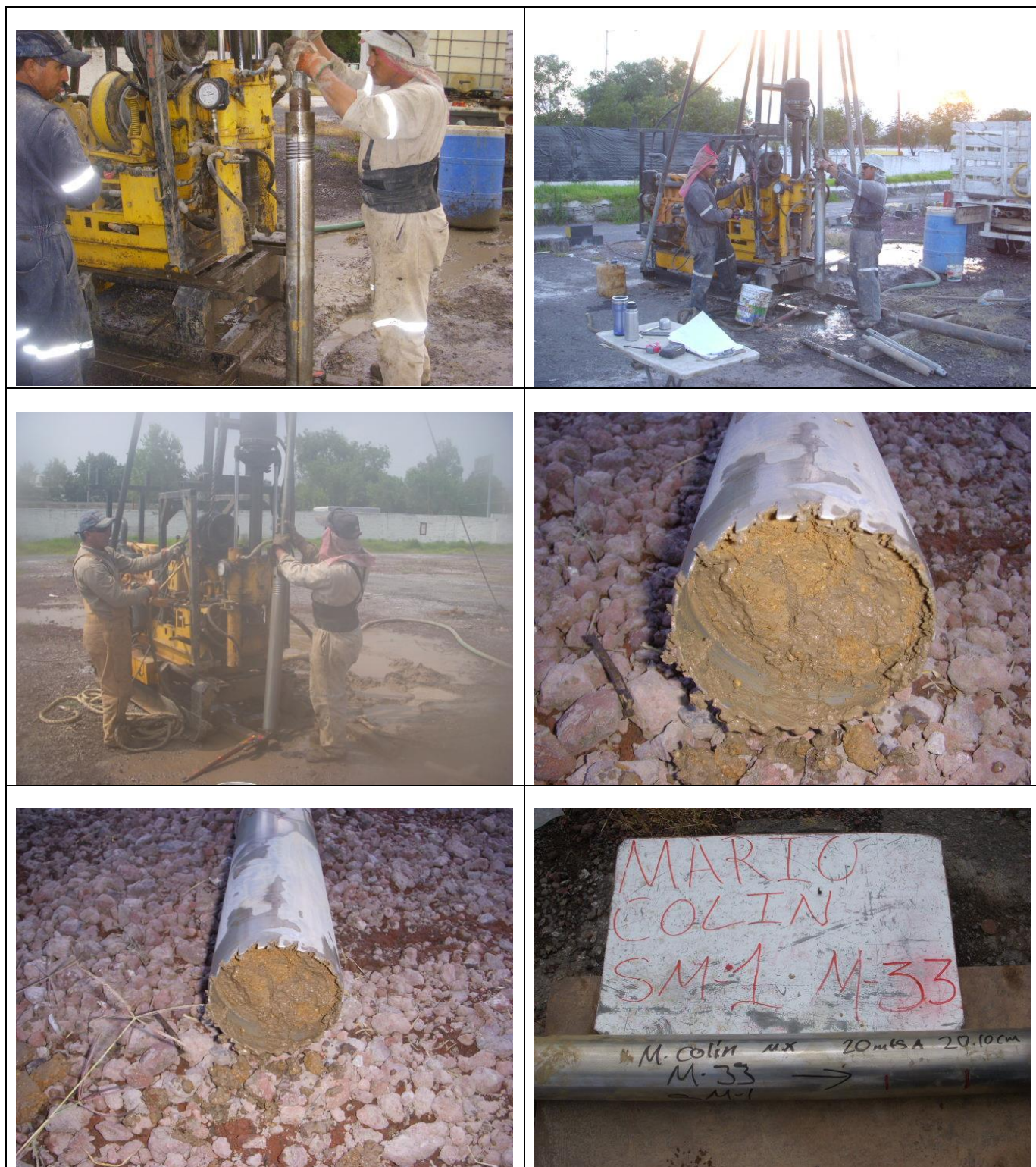
Figura A.13.- Perforaciones para extracción de tubo shelby (SM-A)
