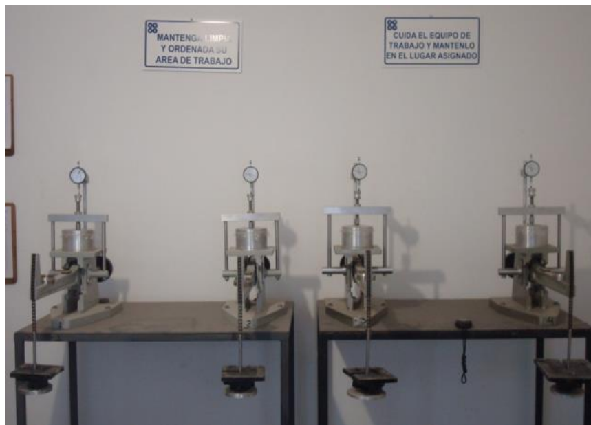
Figura A.19.- Equipos edométricos, para conocer el comportamiento volumétrico (expansión) de los materiales detectados en la zona de estudio
