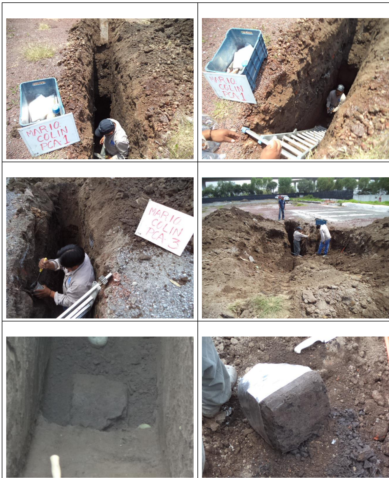
Figura A.17.- Obtención de muestras alteradas para la caracterización de los materiales que conforman los estratos del subsuelo, así como el espesor de la capa activa y de muestras cúbicas inalteradas para la determinación de sus parámetros geomecánicos.
