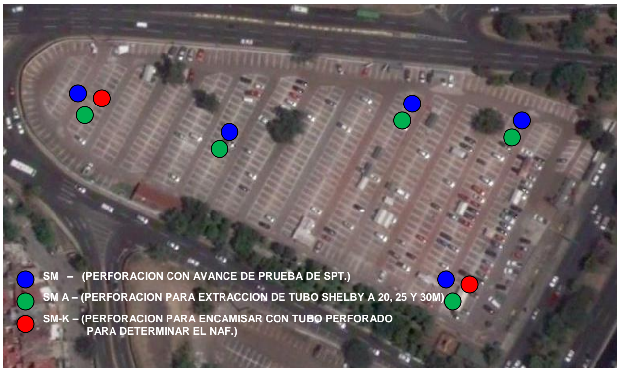
Figura A.6.- Ubicación de los sondeos mixtos, perforaciones para extracción de tubo shelby, perforaciones con tubo perforado, posicionados mediante sistema de Posicionamiento global (GPS)
