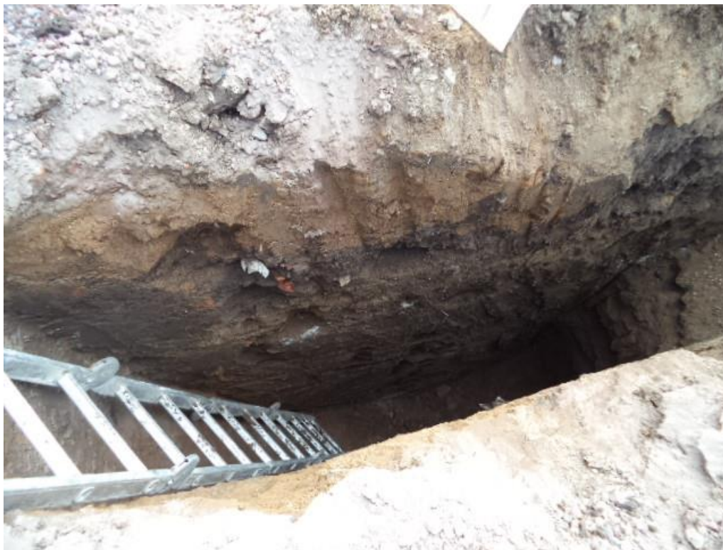
Figura A.15.- Estratigrafía general del predio, donde se tienen estratos conformados por arcilla (CH) expansiva, limo (ML).
