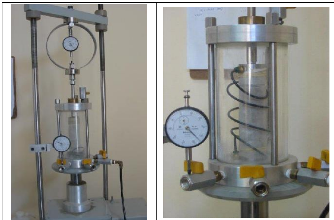
Figura A.20.- Marco de carga para realizar las pruebas triaxiales en suelo a deformación controlada y montaje de una probeta en la cámara triaxial, previo a la prueba triaxial de compresión del tipo UU
