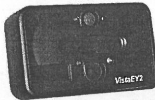
Ilustración 11. Escáner de iris para estación de trabajo "ENROLAMIENTO BIOMÉTRICO"
