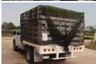
Malla sombra cubriendo la estructura metálica del camión para evitar la deshidratación de las plantas.
