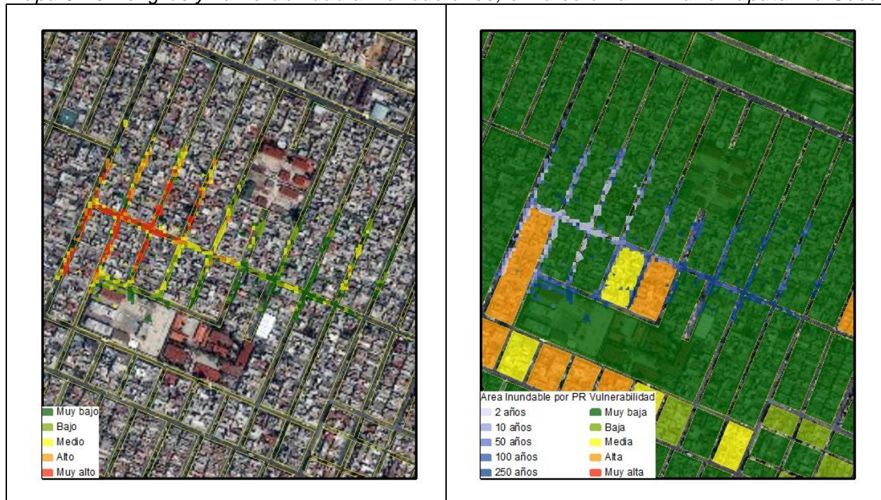
Mapa 5.40 Peligros y vulnerabilidad a inundaciones, en la colonia Emiliano Zapata 1ra Secc.
