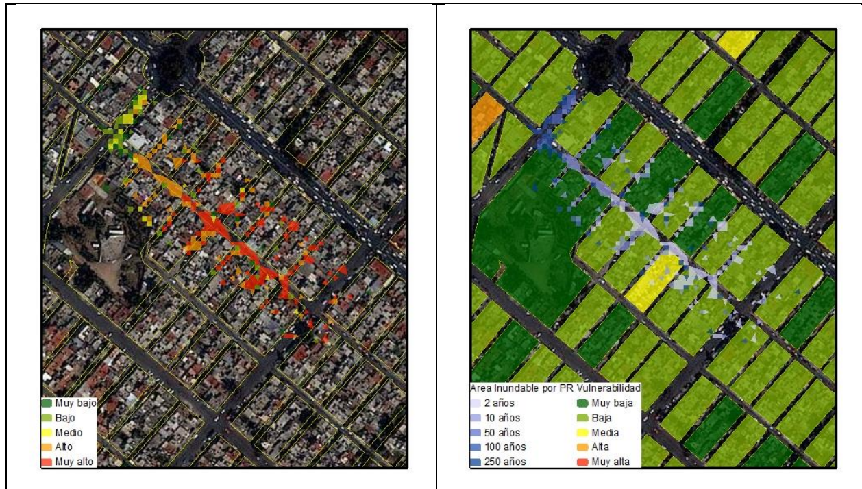
Mapa 5.34 Peligros y vulnerabilidad a inundaciones, en las colonias Prados de Santa Clara, Jardines de Santa Clara.
